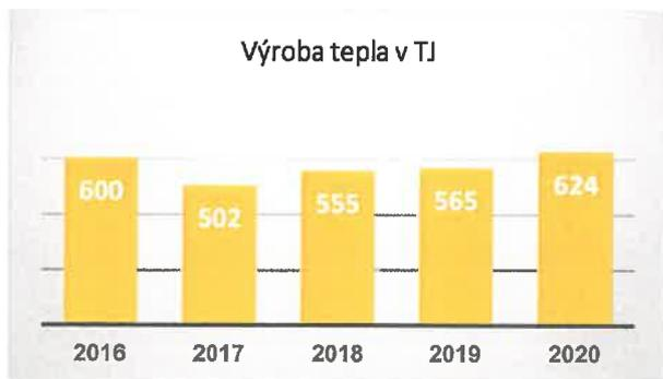
V roce 2016 a částečně ještě v roce 2017 se na výrobě tepla podílely mazuto-plynové kotle K3 a K4, které byly v roce 2017 odstaveny a demontovány. Od roku 2019 se na výrobě, spolu s kotlem K5, už podílí i nový horkovodní kotel K6.
